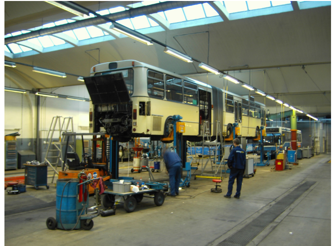
Es kann losgehen: aufgebockt steht der SG 240 H am Freitag (19.01.07) auf der Hebebühne im Betriebshof West, den er – mit defektem Motor – noch aus eigener Kraft erreicht hat.
