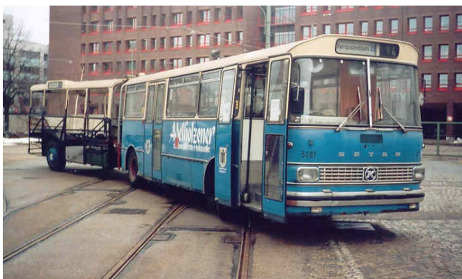
In diesem Zustand fuhr der SG 180 S die 100 km von München nach Neumarkt (St. Veit) aus eigener Kraft – der Vorderwagen ist noch original, der Nachläufer ist bereits komplett neu aufgebaut und fast fertig für die Verblechung! Das Bild entstand im Dezember 2005 im inzwischen abgerissenen Bahnhof 3.
