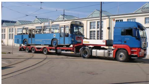
Abfahrtsbereit: Bus 4632 auf dem Tieflader vor dem MVG-Museum. Eine Überführung aus eigener Kraft erschien uns aufgrund der fortgeschrittenen Rostmängel zu riskant.
