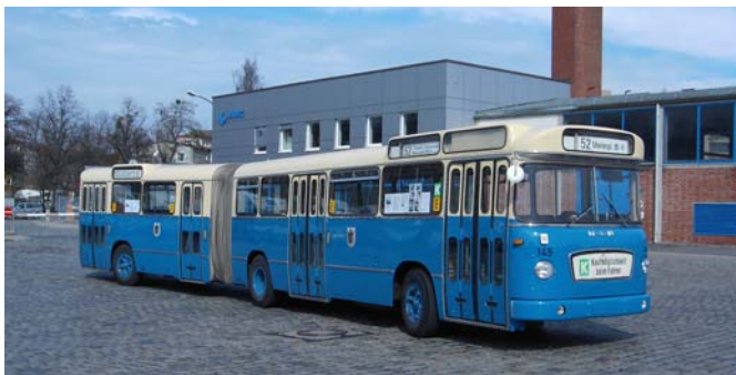
An seiner Wiederzulassung für den Straßenverkehr wird gerade kräftig gearbeitet: der älteste existierende MAN-Gelenkbus überhaupt und zugleich natürlich der älteste Münchner Gelenkbus ist OCM-Museumsbus 5 (MAN/Göppel 890 UG M 16 A, Baujahr 1965). Zum Jubiläum im Herbst wird der Bus jedoch vorerst noch als Standmodell ins Museum zurückkehren.
