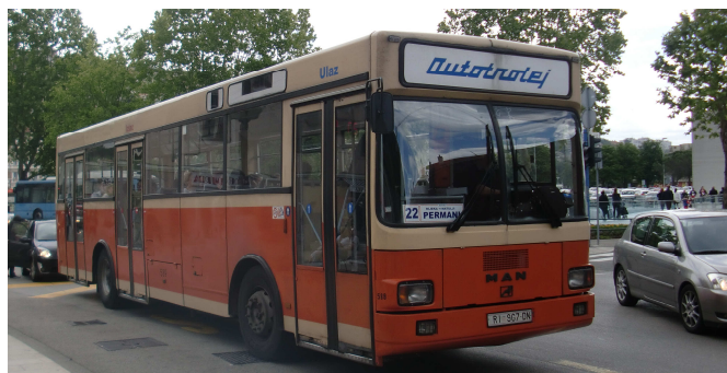
„SL II“ mit Mittelmotor: MAN/Avtomontaza SU 240, Wagen Nr. 588. Auch von der Gelenkbus-Variante SG 240, ebenfalls mit Mittelmotor, sind noch etliche Fahrzeuge in dreitüriger Version (VM-H) im Einsatz.
