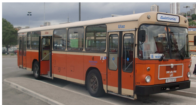
Nur noch wenige MAN/Avtomontaza SU 220 in dreitüriger Version waren im Mai 2013 in Rijeka noch im Einsatz, hier Wagen 470 am „ZOB“. Die „hochbeinigen“ SL I mit Mittelmotor waren früher in den (ehemaligen) jugoslawischen Staaten weit verbreitet.
