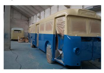
Arbeiten an den Fahrzeugen..... An Museumsbus 4632 (MAN SL 200, 1980) wurden zwei Wasserverluste behoben, außerdem der Getriebeölwechsel durchgeführt. Vor der nächsten SP im Juli muss ein Kugelkopf von der Lenkung getauscht werden, außerdem haben die Gestänge der Höhensteuerventile zuviel Spiel und müssen ebenfalls erneuert werden. Außerdem ist der Hinterachsölwechsel fällig.
