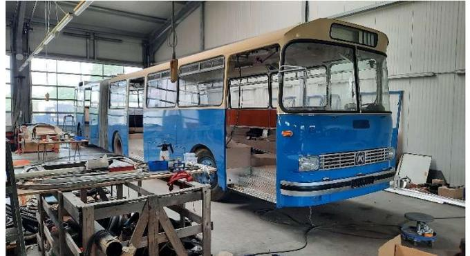
Der riesige Berg an Teilen wird immer kleiner, der betreffende Bus immer kompletter: Kässbohrer-SETRA SG 180 S ex SWM 5107 (Baujahr 1975) am 04.06.2022 bei der ausführenden Firma in Neumarkt/St. Veit. Foto: OCM
