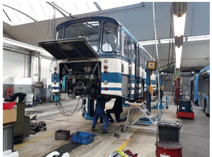
Die OCM-Werkstattgruppe in Aktion: im Busbetriebshof West der MVG wird der Motor des Büssings ausgebaut.
